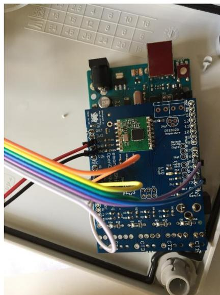
**Ilustración 7.- Detalle Conexiones Arduino UNO, modulo 1**
