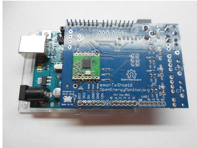
Ilustración 5 Arduino con shield de comunicaciones
