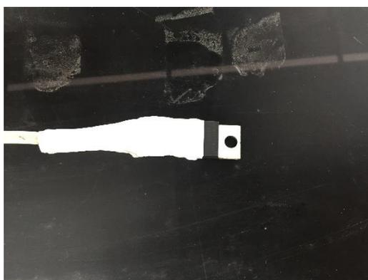
**Ilustración 4- Instalación Sensor Temperatura placa**
