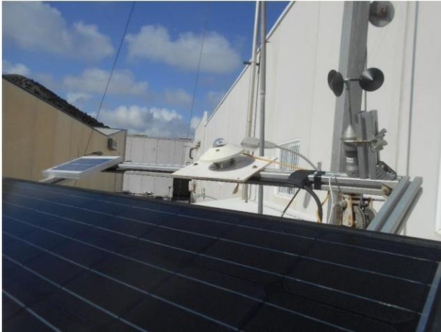
Ilustración 5.- Detalle Equipos Instalados en Seguidor
