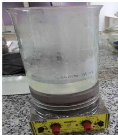
*Figura 3.3: Disolución de Montmorillonita en agitación*
