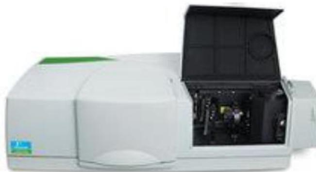
*Figura 0.10: Espectrofotómetro UV/Vis.*
