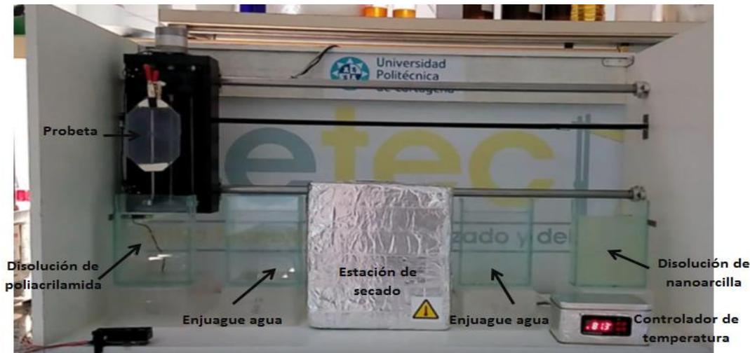
*Figura 3.5. Equipo de inmersión automático utilizado en el proyecto.*
