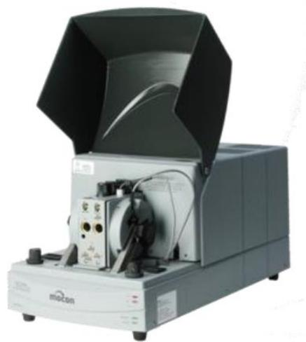
*Figura 3.6. Permeabilímetro utilizado en el análisis de las muestras*
